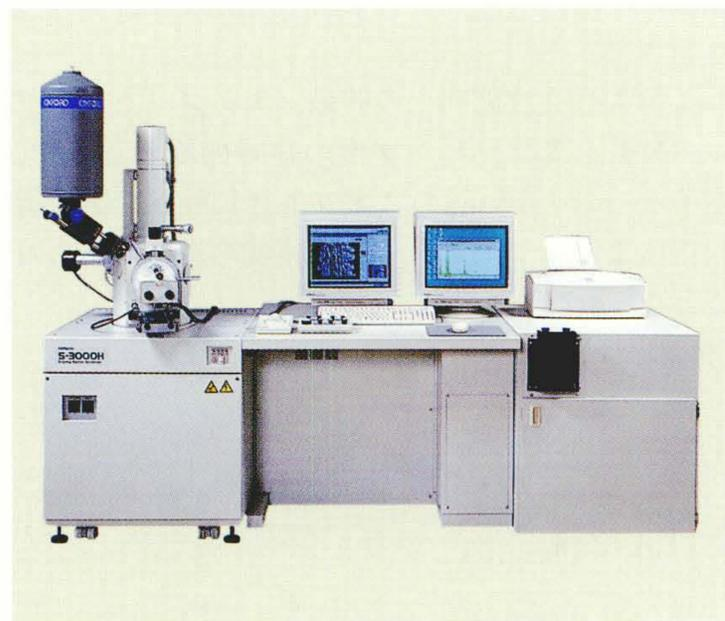
走査電子顕微鏡とエネルギー分散型X線分析装置の複合装置“SEMEDX”
