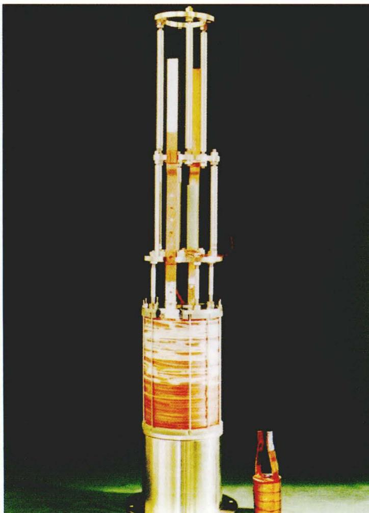
世界最高磁場を発生した二つのビスマス系高温酸化物超電導マグネット
