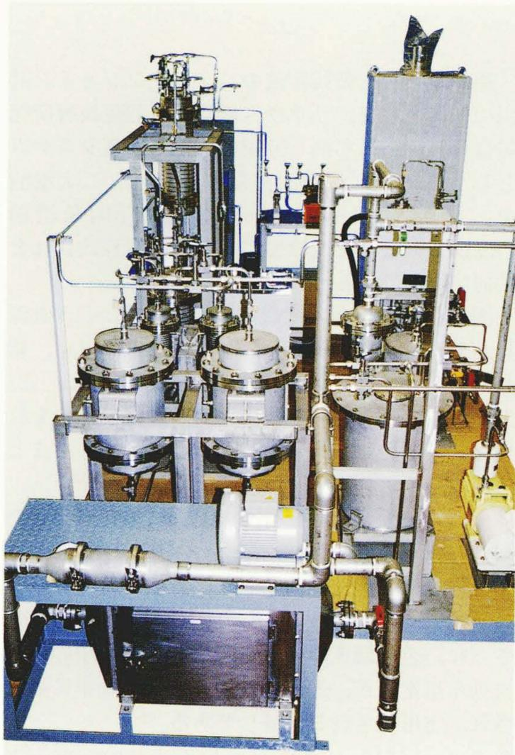
フッ化物揮発プロセスの試験設備
