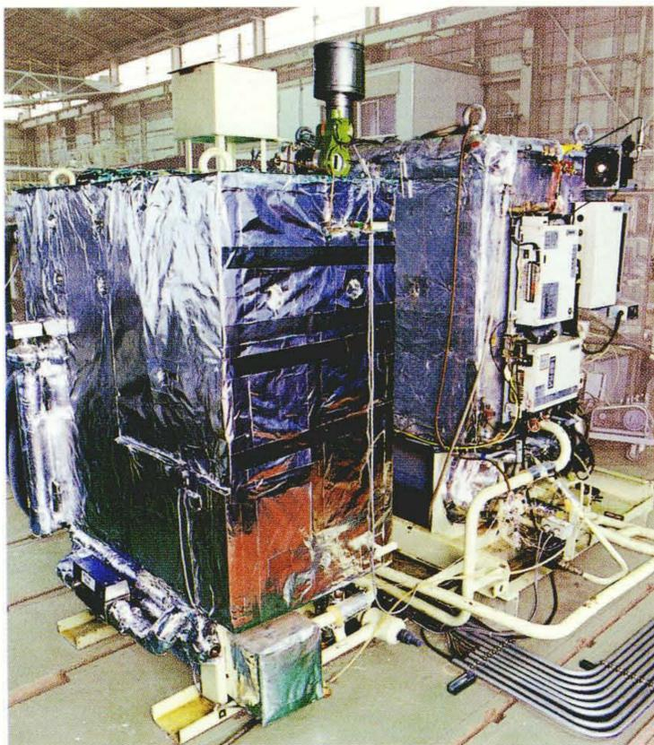
氷温吸収冷凍機の試作機(冷凍能力：90 kW)の外観
