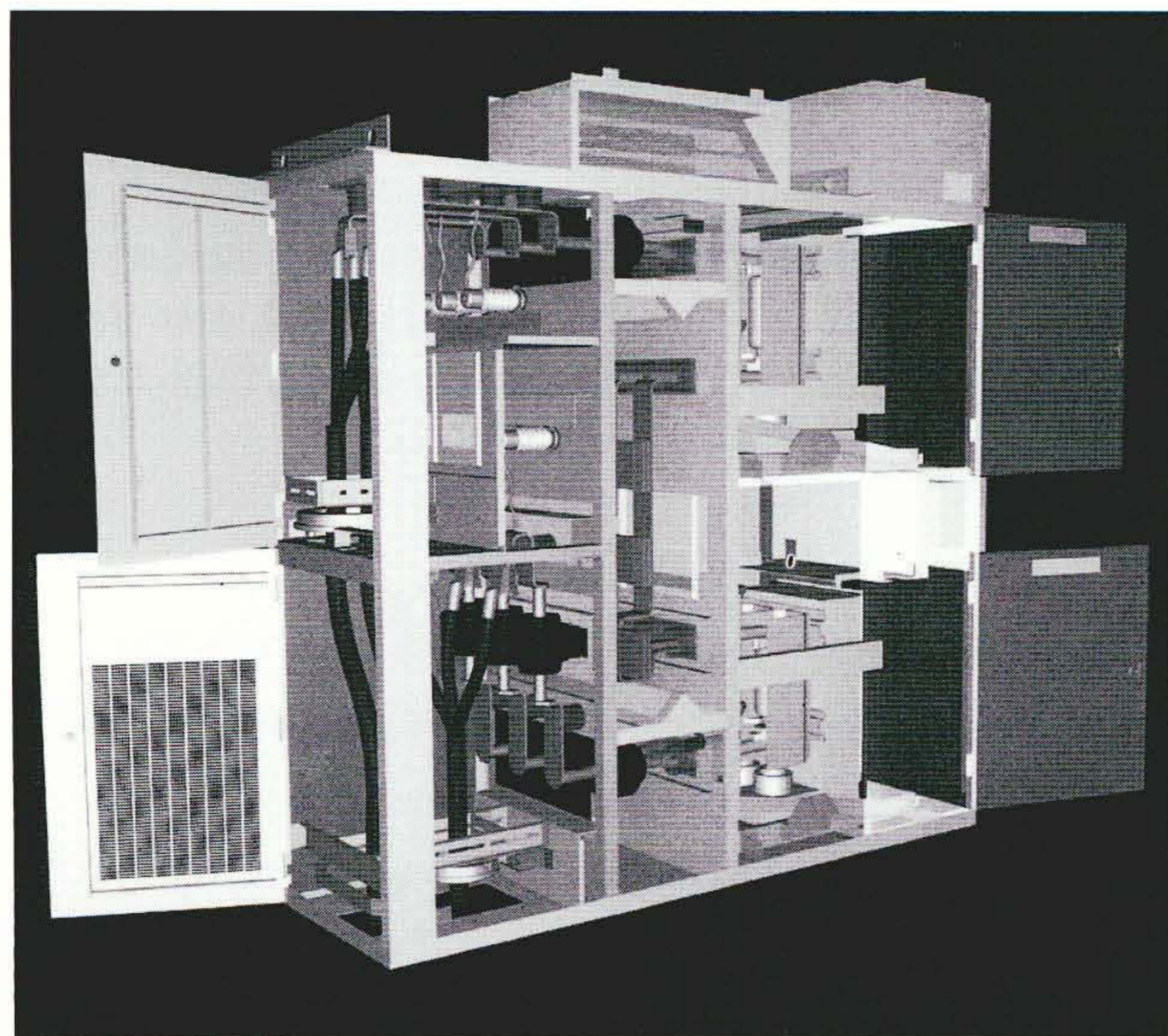
図1 三次元CADによる高圧スイッチギヤの配置検討
