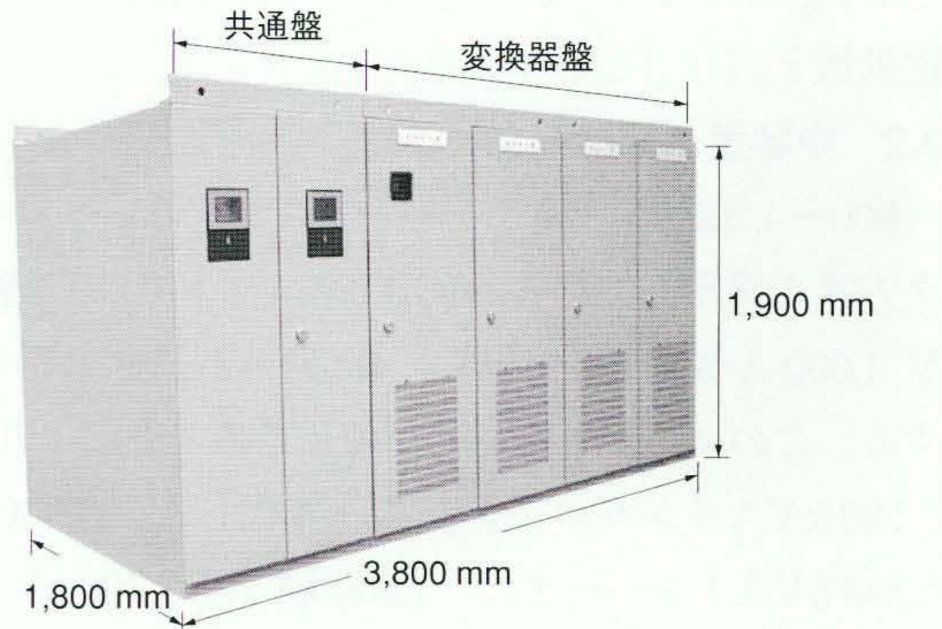
図3 主機 IGBTインバータ 主機IGBTインバータは、共通盤1面と、容量によって1面から最大4面の変換器盤で構成する。4面構成の4,400 kVA変換器盤を図に示す。
