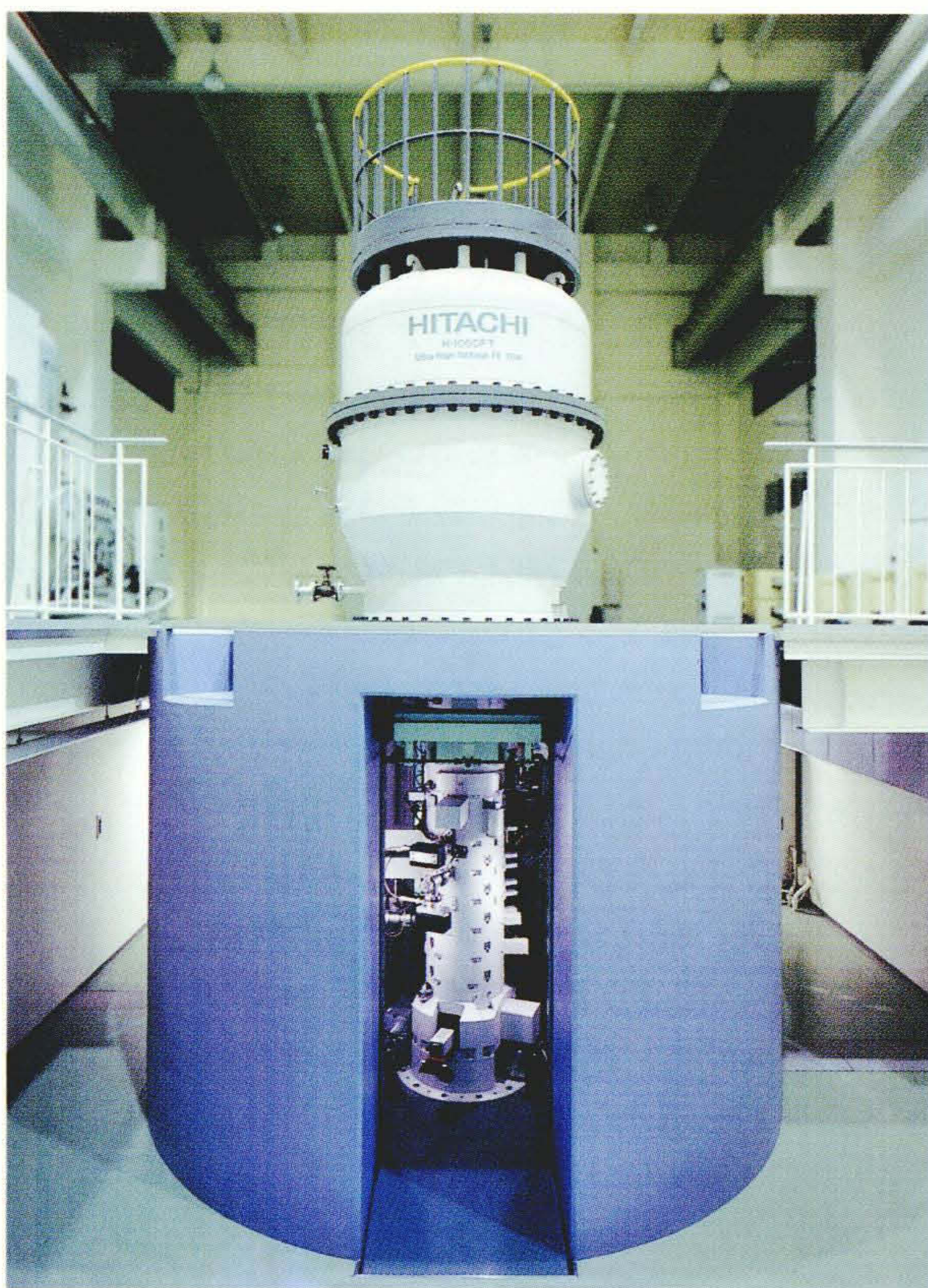
1 MVホログラフィー電子顕微鏡の外観
