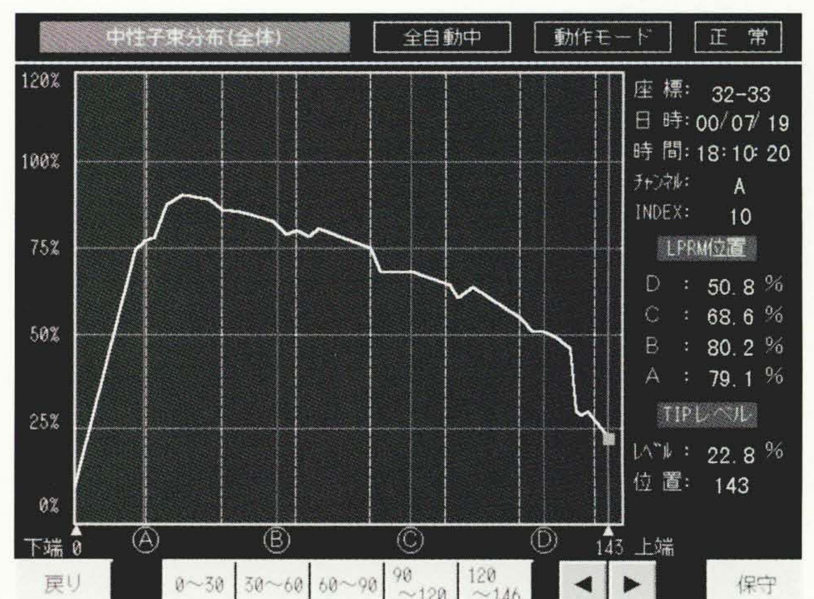
図3 移動式炉心内計装装置の画面例
