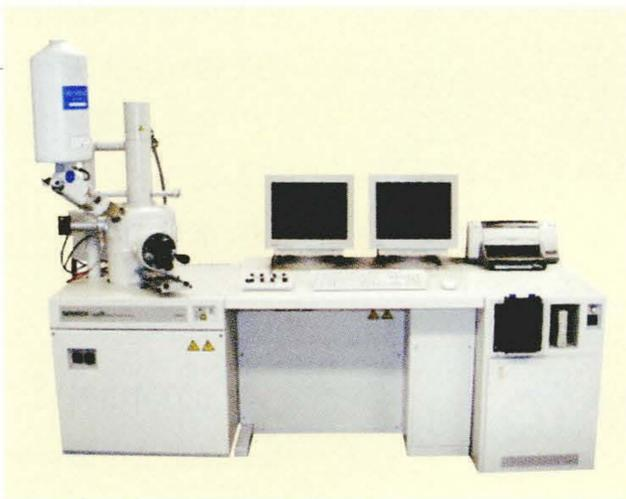
**半**導体や材料の分野では、SEM(走査電子顕微鏡)とEDX(エネルギー拡散X線装置)を組み合わせて観察と分析を同時に使うケースが多くなっている。従来、機能的に独立した両者を組み合わせていたために、操作が煩雑で、双方の機器に応じた操作上のノウハウの蓄積が必要とされていた。
