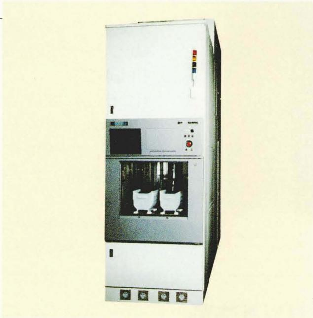
**工** ピタキシャルSiGe成長装置“VERTEX-V (SE)”〔200 mm (8インチ)以下のウェーハ対応〕は、今後拡大が期待されるSiGeデバイスの需要に対応するために、VERTEXシリーズの高生産性・低COO (Cost of Ownership)という特徴を生かし、SiGeデバイス量産ライン対応の装置として開発したものである。
