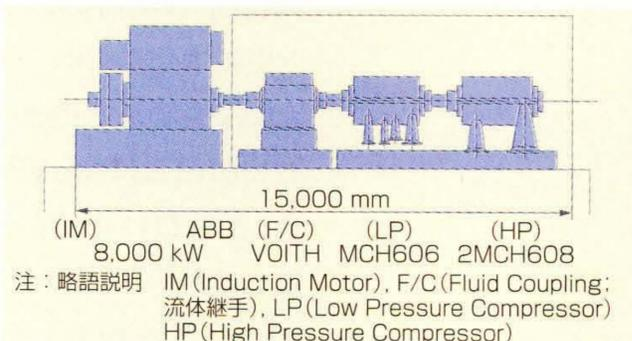
**日**揮株式会社から受注した、Malaysia LNG Tiga納め圧縮機を出荷した。世界最大級のLNG(液化天然ガス)プラント(年間総生産能力:2,300万t)で使用されるもので、エンドフラッシュ圧縮機(8,000 kW)2台と、スタビライザ圧縮機(4,500 kW)2台の計4台である。高効率インペラの採用による高性能と、さまざまな運転条件に対して安定した機械的特性を持っているのが特徴である。
