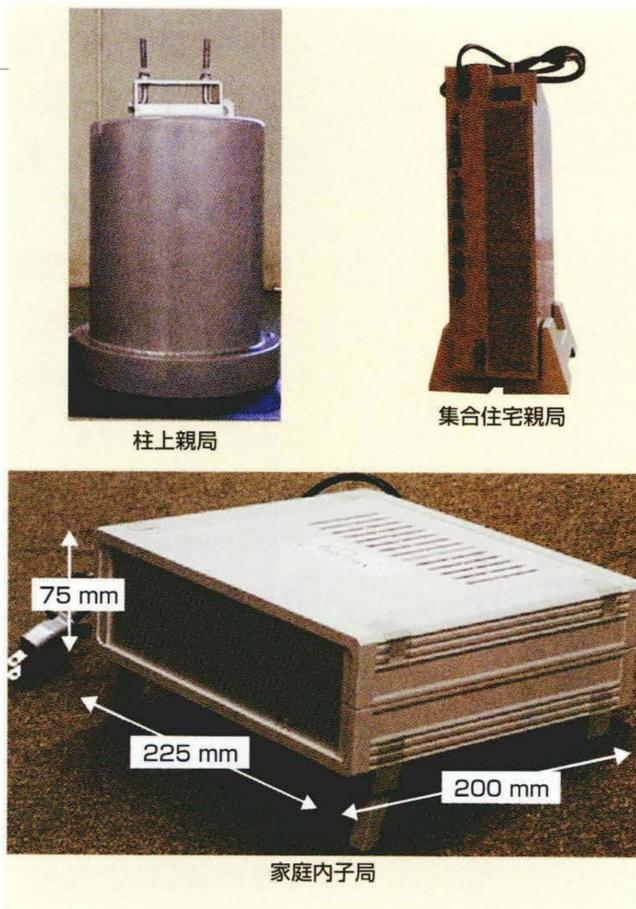
**家**庭への電力引込線を利用し、安価なインターネットサービスを可能とする高速電力線搬送装置を開発した。親局装置は最大20台の子局装置に接続され、現行の電波法に準拠した10 k～450 kHzの周波数帯域を用いて1.4 Mビット/sの高速通信を実現している。
