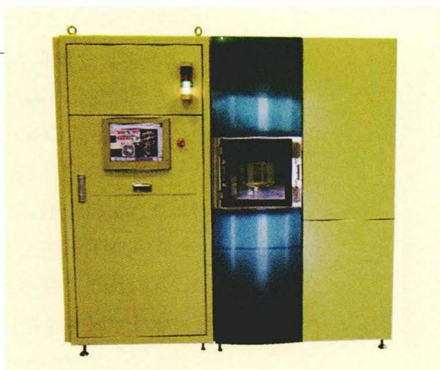
**ハ**ードディスク装置の記憶容量増大や低価格化に伴い、磁気ヘッド自体にも高性能と低価格が求められている。従来の磁気ヘッド用絶縁層成膜装置に比べて膜厚均一化性能と生産能力の向上を図った「カセット to カセット型絶縁膜スパッタ装置」を開発した。
