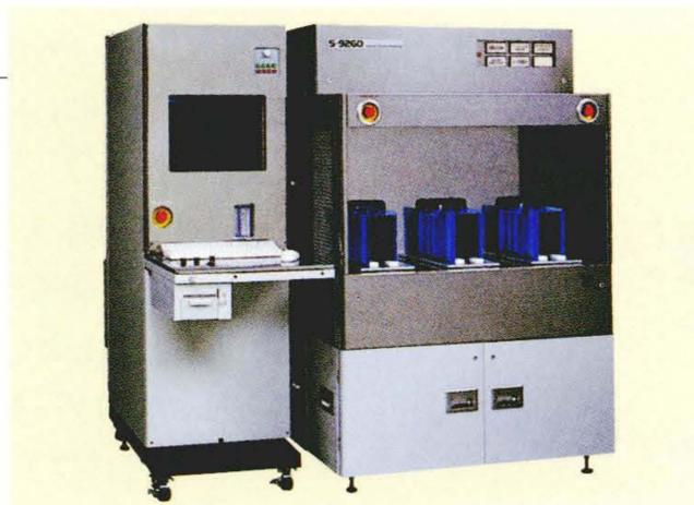
プロセスに対応するため、これまでよりも高精度化と高スループット化を図った全自動の測長装置である。
