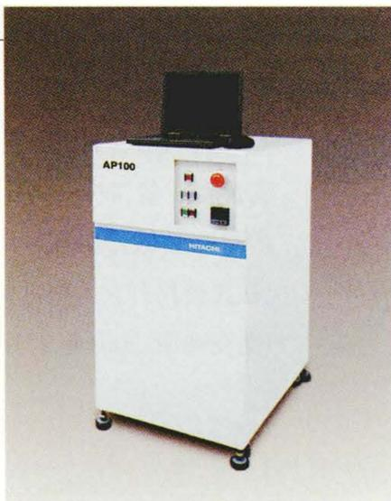
**半** 導体や液晶などの製造工程で使用するガス中不純物濃度管理には、1 ppb(10<sup>-9</sup>)以下の測定が要求され、特に水分、酸素、CO<sub>2</sub>の分析が重要である。
