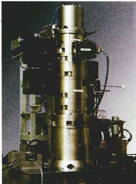
系、低ひずみステージ、高精度温度制御システムなどの新技術を導入している。描画方式には、可変成形ビーム、ベクタースキャン、ステージ連続移動の方式を採用し、加速電圧は50 kV、最大ビーム電流密度は10 A/cm<sup>2</sup>、最大ビームサイズは2×2 μm<sup>2</sup>である。ビームの偏向は3種類の偏向器を用いて行っており、最大偏向幅は約2 mmである。描画データ処理部を二重化することで、描画動作と近接効果補正の並列処理を可能としている。これらにより、スループットの向上と大容量データへの対応を可能としている。
