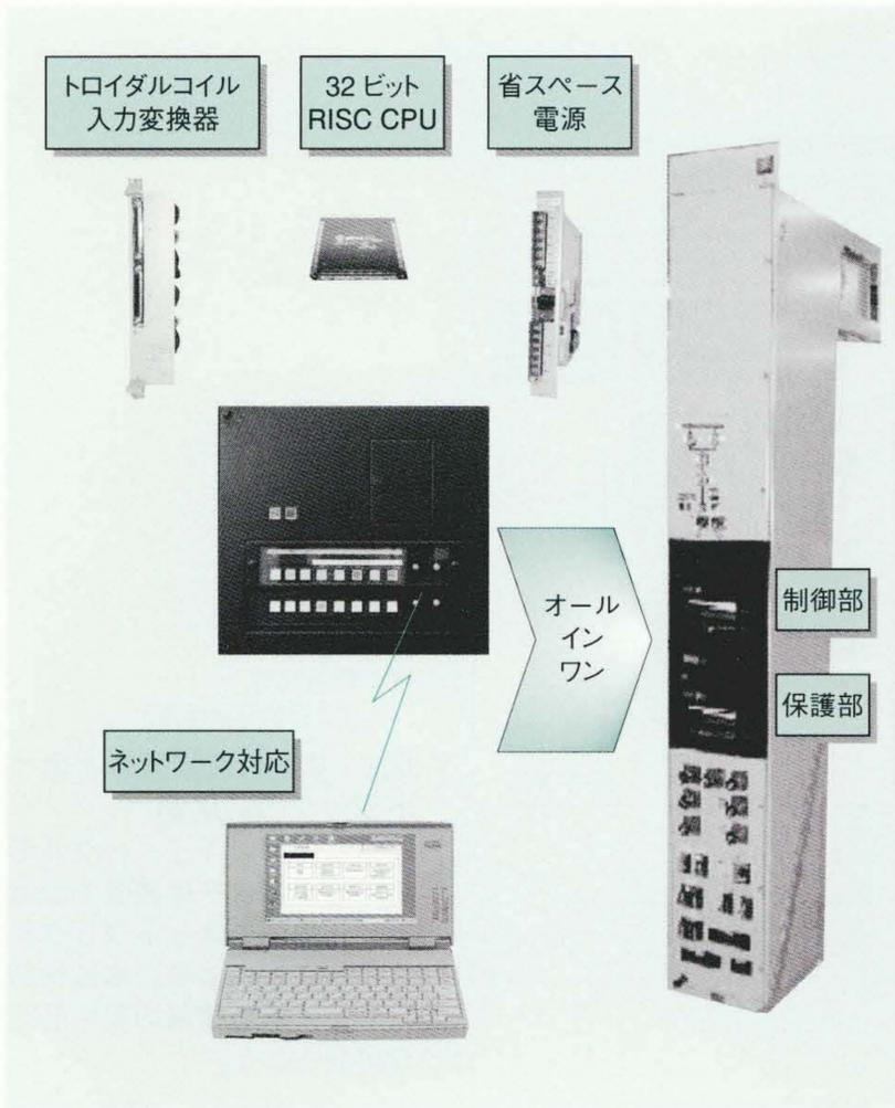
図4 コンパクト形演算ユニットと保護・制御一体形装置
