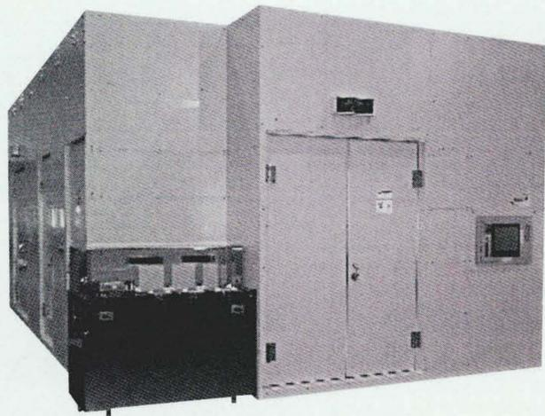
(a) 300 mm径SIMOXウェーハ用イオン注入装置“UI-6000”の外観
