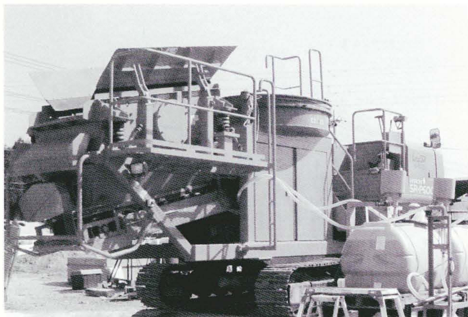
図8 不溶化処理に用いた土質改良機の外観
