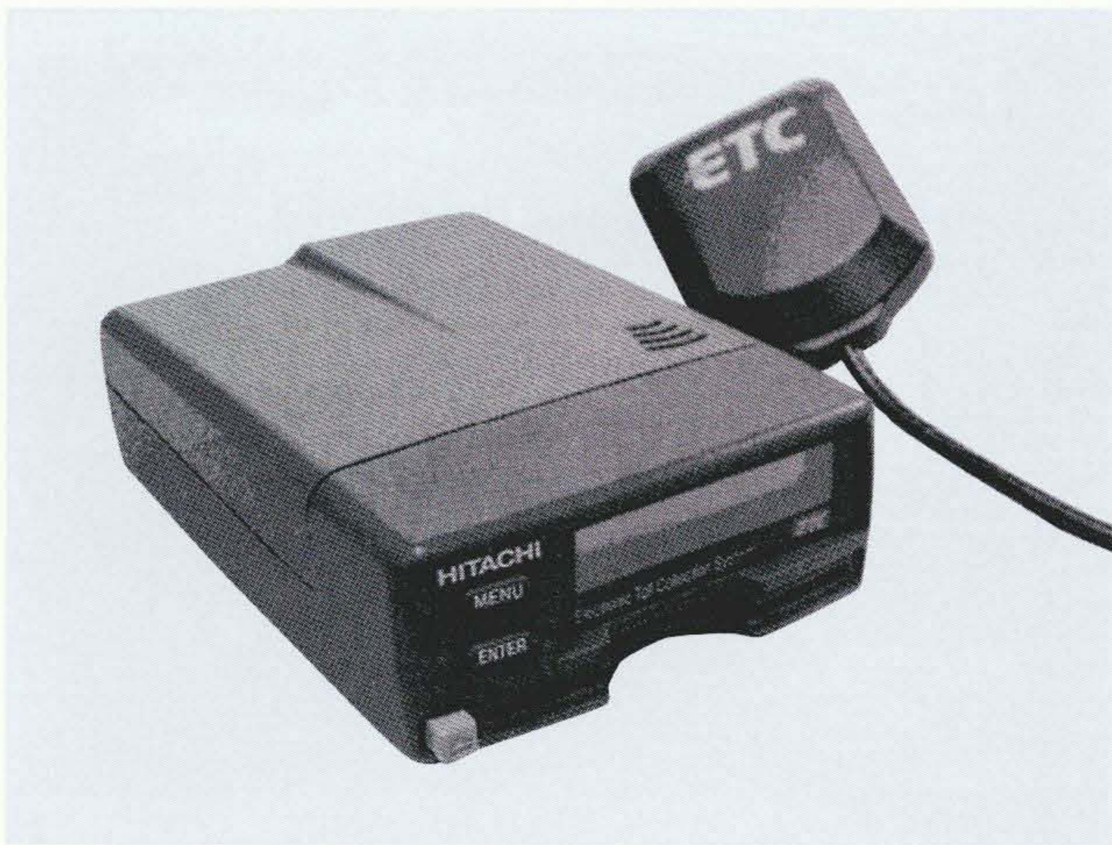
図2 ETC車載器(ARIB STD-T75に準拠)
