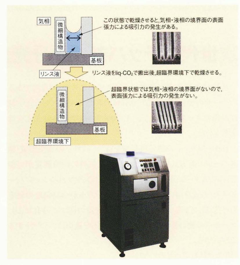
超臨界乾燥法の原理(上)と、微細構造乾燥装置"SRD-2020"の外観(下)
