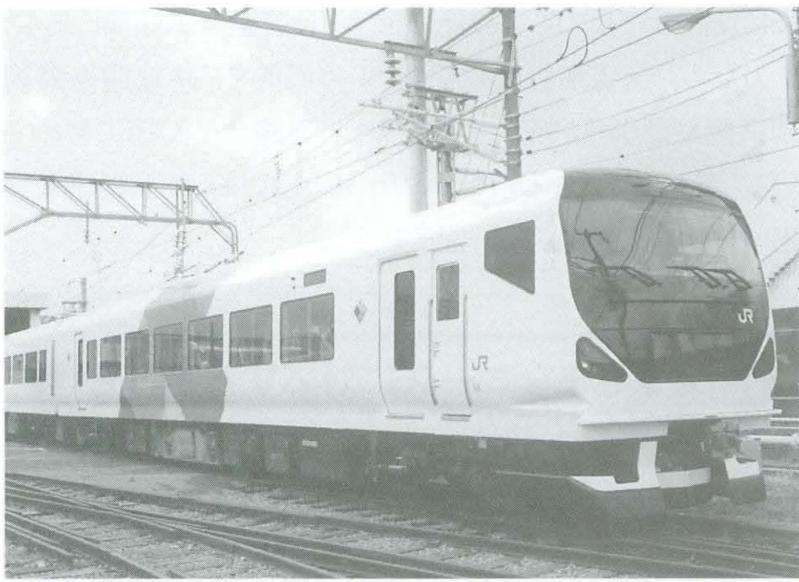
図3 東日本旅客鉄道株式会社納めE257系特急形直流電車 A-trainでは、E257系特急形直流電車を含め、延べ1,000両を超す受注実績がある。
