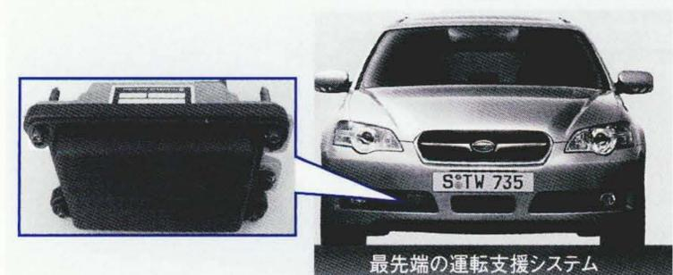
ADAシステムを搭載した富士重工業株式会社のスバル レガシ ツーリングワゴン3.0R(右)と、採用された日立製作所のミリ波レーダ(左)
