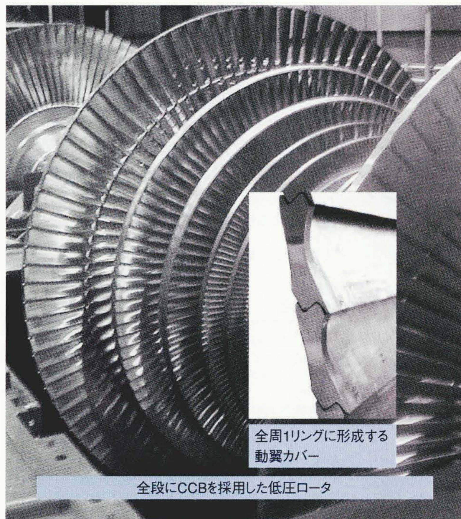
図3 CCBを全段に採用した低圧ロータの外観
