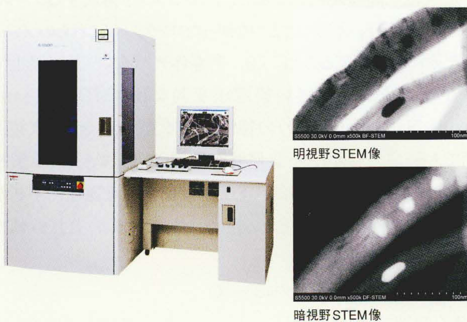
インレンズFE-SEM「S-5500形」の外観(左)と カーボンナノチューブの観察例(加速電圧30 kV)(右)
