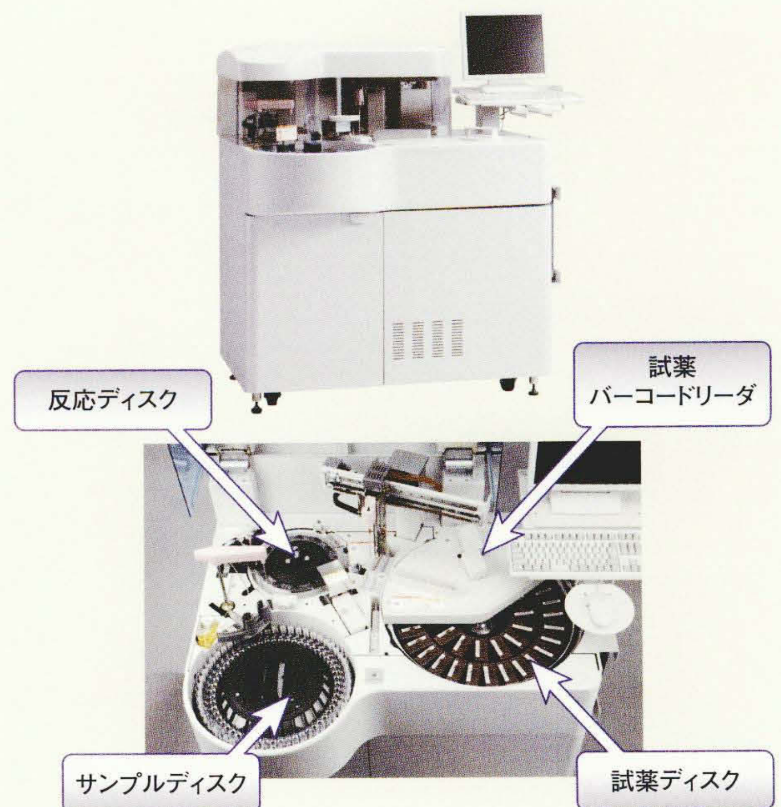
血液自動分析装置“LABOSPECT 003”の外観(上)と主要部分(下)
