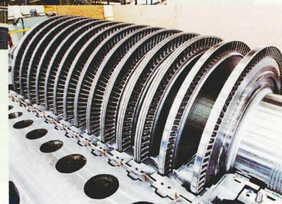
英国スポルディングエナジー社納めコンバインドサイクル発電設備向け蒸気タービン
