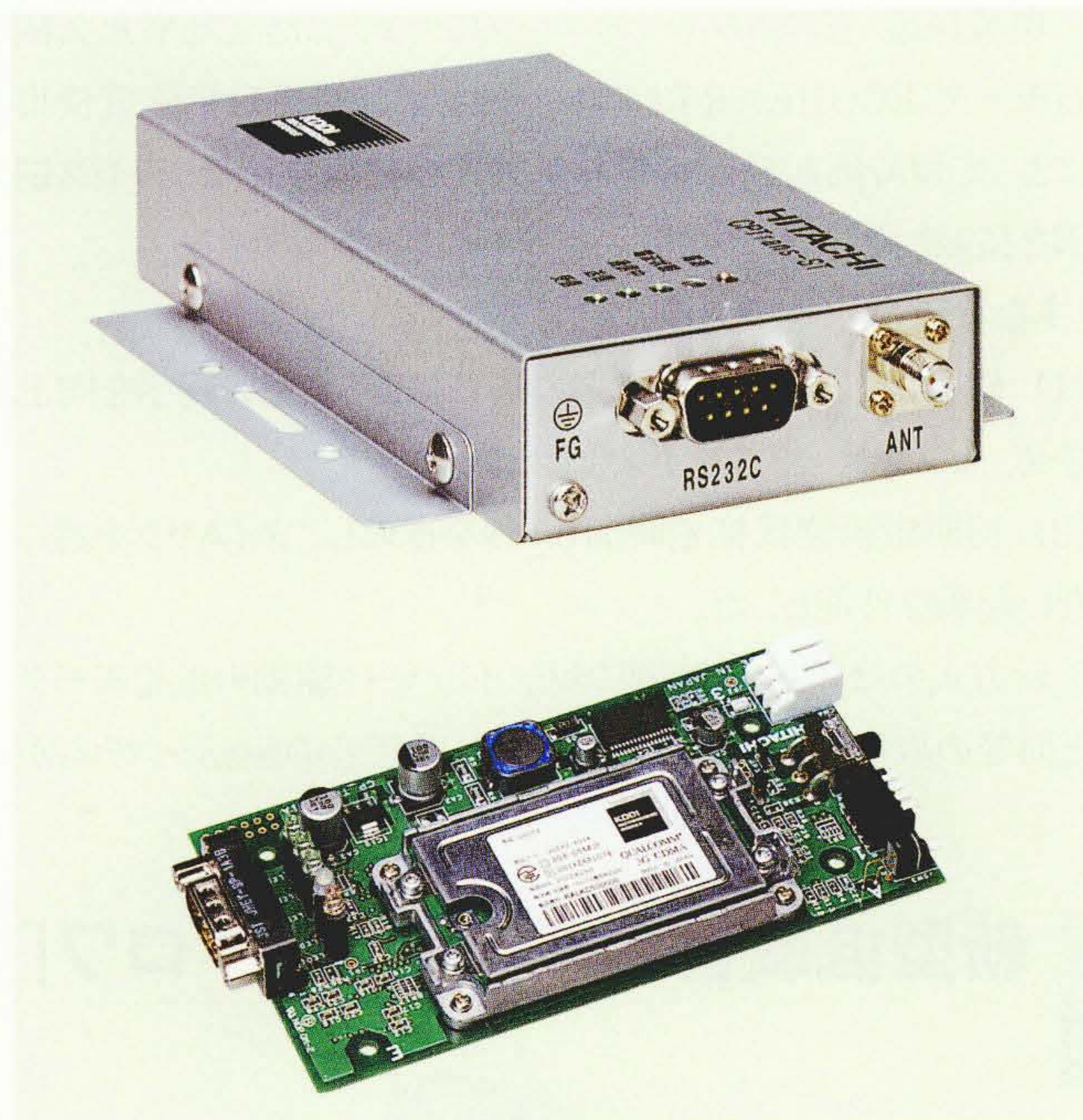
CDMAデータ通信端末“CPTrans-ST”の外観(上)と組み込み用途タイプの外観(下)
