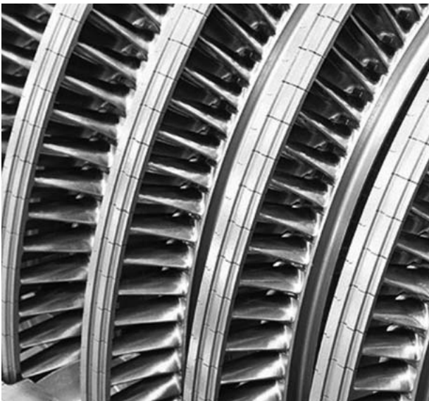
図3 CCB採用高圧タービン動翼の例 動翼先端カバー部は、一体削り出し構造である。
