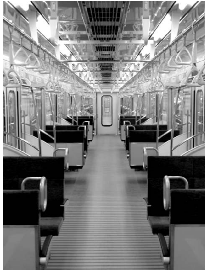
図2 TX-2000系車両の客室内 長距離を走行するTX-2000系は、セミクロスシートを採用し、車両中央部の屋根上に非常換気装置を設置している。
