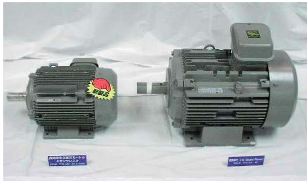
22 kWモートルの外観比較 左:永久磁石モートル, 右:誘導電動機
