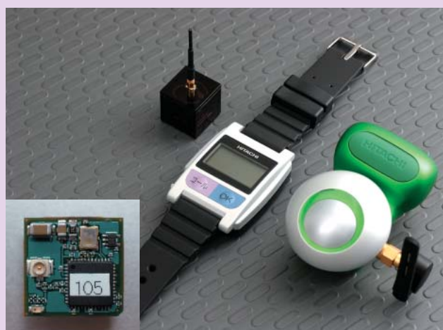
15 mm角のセンサノード基盤(左下)と(左から)キューブ型、腕時計型、壁掛け型のセンサノード
