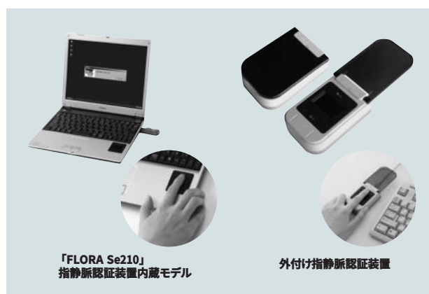
図4 SPCへの指静脈認証装置の適用
