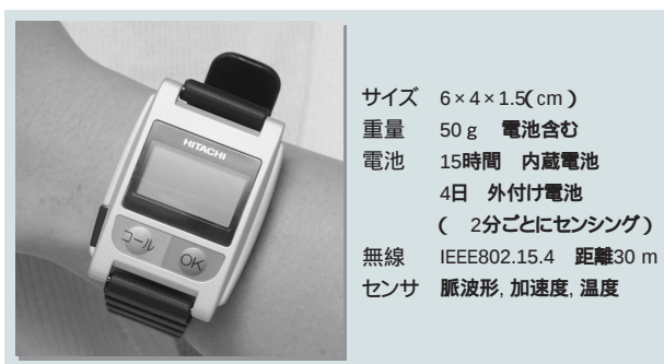
図4 腕時計型の「ライフ顕微鏡」システム PCに接続された基地局と無線通信によりデータを転送する。
