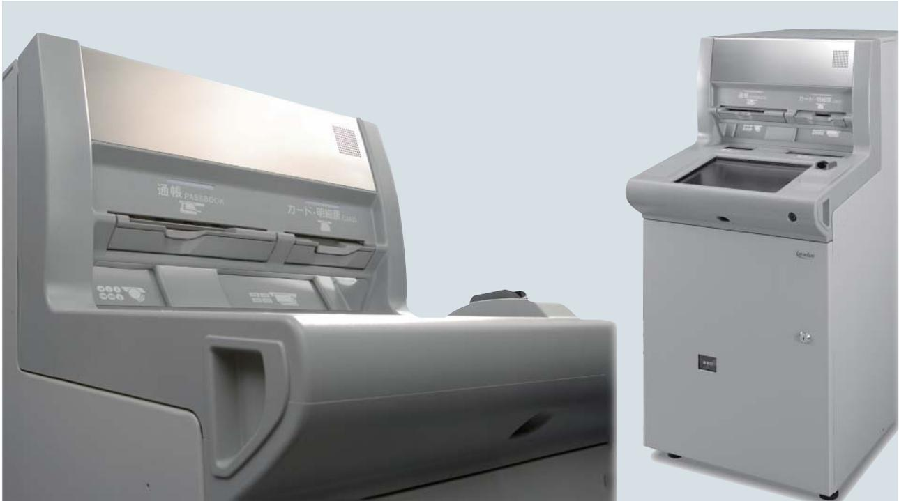
図1 多様なユーザーの利用を想定して開発を行った標準型ATM「AK-1」
