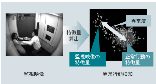
図5 エレベーター内異常行動検知サービスの概要 事前に学習させた正常行動の特徴量と監視映像の特徴量の差で異常行動を検知する。
