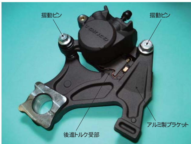
二輪車用アルミブラケット一体型リヤキャリアの外観
