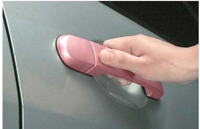
自動車用ドアグリップ式指静脈認証装置の外観
