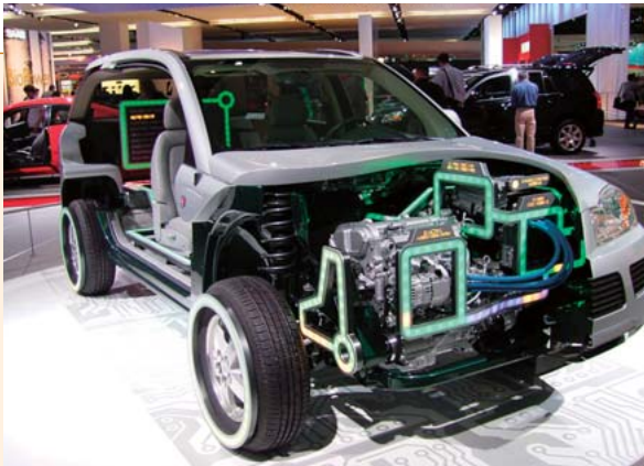
「Saturn Vue Green Line Hybrid」のハイブリッドシステム構造
