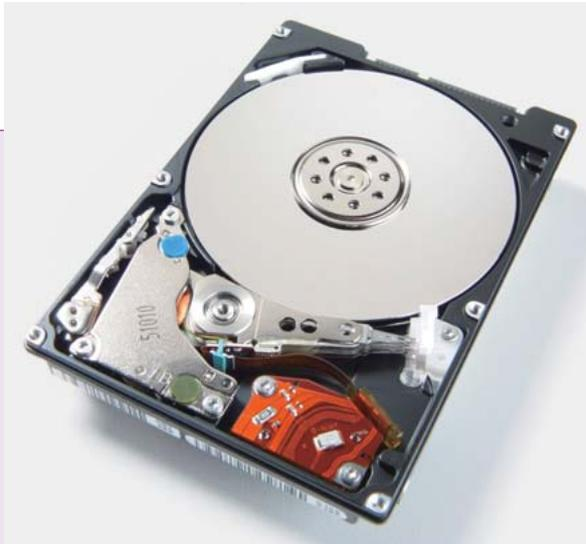
垂直磁気記録方式採用のHDD
