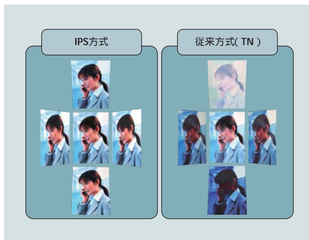
図5 IPS方式と従来方式の視野角比較
