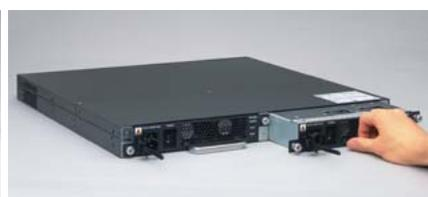
抜可能な内蔵電源を二重化して搭載することができ、高信頼ネットワークに使いやすいモデル構成とした。また、既存のAX3630Sシリーズの豊富な機能を継承したうえで、さらにアクセスコントロールリストにアウトバウンド側の条件を設定できるようにしたため、より柔軟なフィルタ設定が可能になっている。
