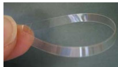
9 ガラスエポキシ基板付き光導波路の断面(上)とフレキシブル光導波路(下)
