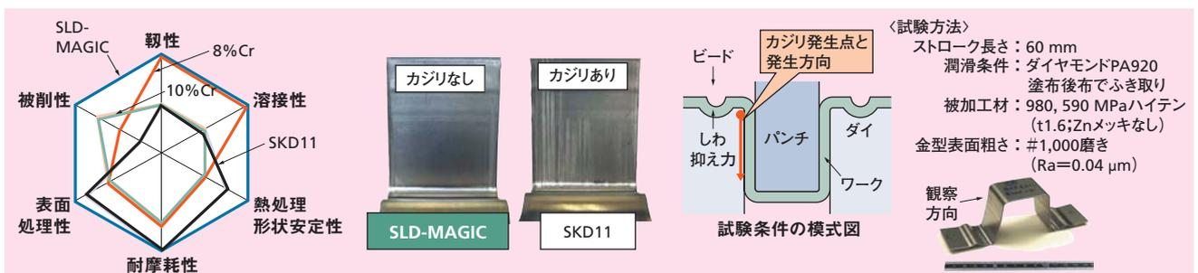
6 左：SLD-MAGICと既存鋼(SKD11,8Cr,10Cr)の各特性の比較(左)とハイテンの曲げによる耐摩耗性評価(右)
