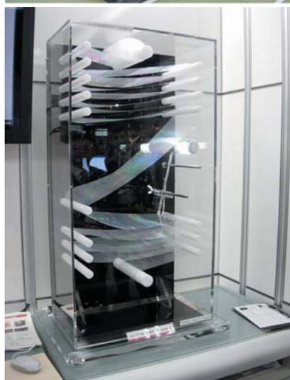
1 シートナノインプリント装置(幅2.9 m、奥行き1.4 m、高さ2.1 m)と転写サンプル(長さ12 m)
