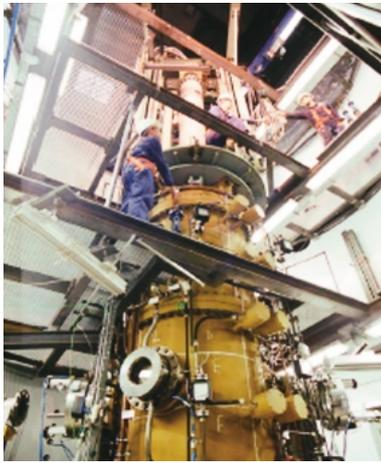
図10 ドイツアーヘン工科大学の酸素燃焼試験装置
