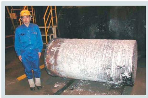
図5 FENIX-700大型鋼塊の外観
