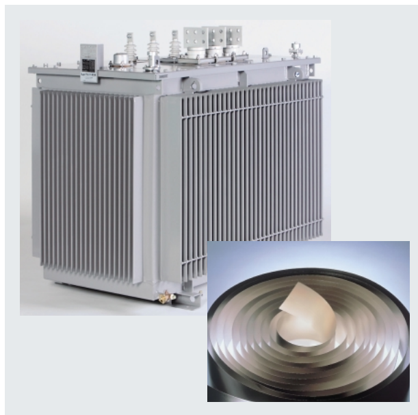
図5 アモルファス変圧器とアモルファス合金薄帯 アモルファス変圧器(上)とアモルファス合金薄帯(下)の外観を示す。アモルファス合金薄帯「Metglas 2605SA1」は変圧器の鉄心材料として使用される(写真提供:株式会社日立産機システム)。
