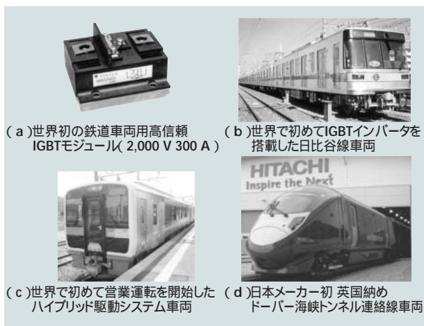
図7 世界初の鉄道用IGBTモジュールとIGBTを搭載した車両
