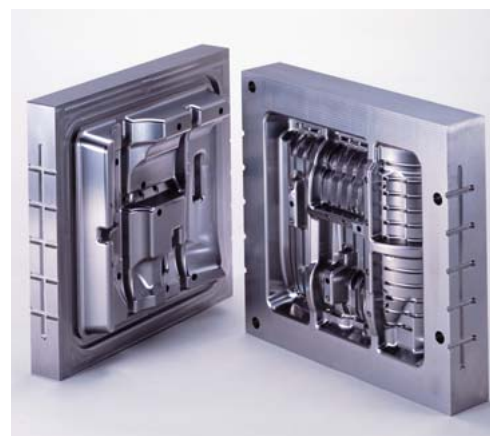
6 ウェルドライン対策成形用金型の例
