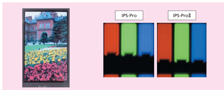
2 携帯電話用 3 インチワイド VGA の外観(左)と、IPS-Pro/IPS-Pro IIの比較(右)
