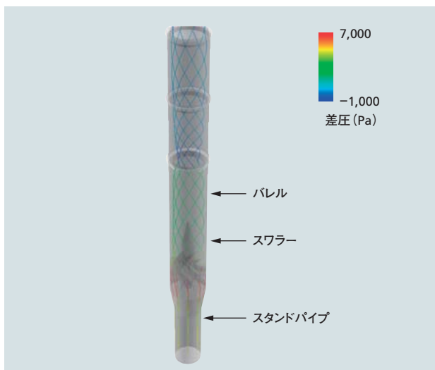
図6 低圧損型セパレータの概念図(流線および出口との差圧)
