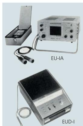
[8] 真空管式Aモード装置(上)と胎児心音装置(下)
