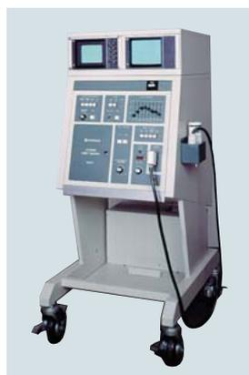
[9] セクタ電子走査方式装置
