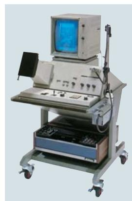
[10] リニア電子走査方式装置(世界初のデジタルスキャンコンバータを内蔵)
