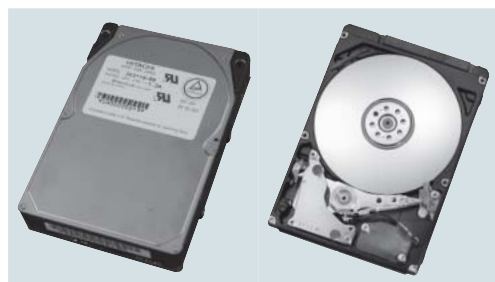
[5] 日立初の2.5型HDD (1994年: 680 MB) (左) と現在の2.5型HDD (2009年: 500 GB) (右)。容量は約735倍に増加している。
