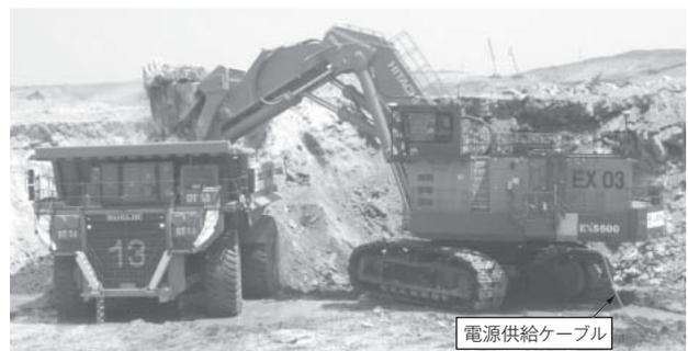
図3 稼働中の電動式油圧ショベルと超大型ダンプトラック
