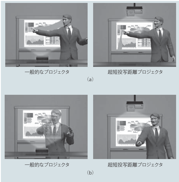
図12 超短投写距離プロジェクタ「A100シリーズ」の特徴 従来のプロジェクタでは避けられなかったプレゼンター自身の映り込み(影)が大幅に低減できる。プレゼンターが前を向いても、プロジェクタからの光が眼に入らないため、まぶしくないという特徴がある。
