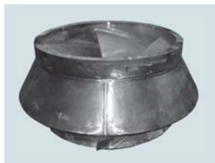
図5 溶接構造オープン羽根車の外観 図6 溶接構造クローズ羽根車の外観 (外径 約φ1,470 mm) (外径 約φ1,420 mm)
