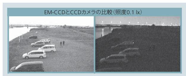
**図5 EM-CCDカメラ画像の例**
