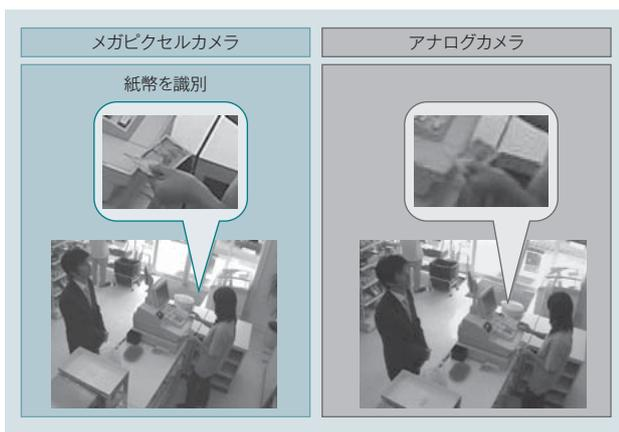
図2 メガピクセルカメラとアナログカメラの画像比較例
