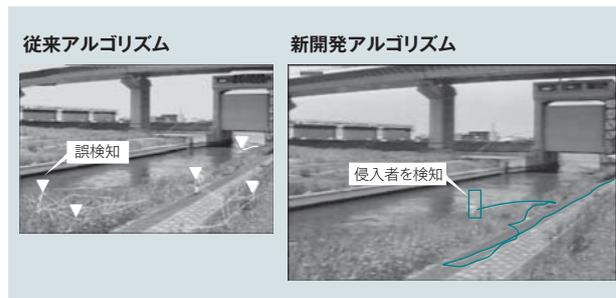
図8 新旧の物体検知アルゴリズム処理例
