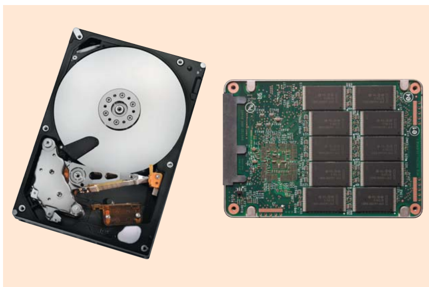
1 2Tバイト3.5型HDD〔Ultrastar A7K2000〕(左)、開発中のSSDの内部構造(右)
