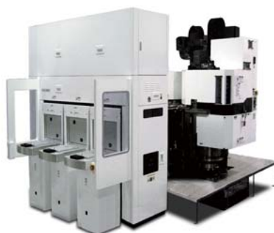
2 マイクロ波 ECR プラズマエッチング装置 「M-8190XT」
