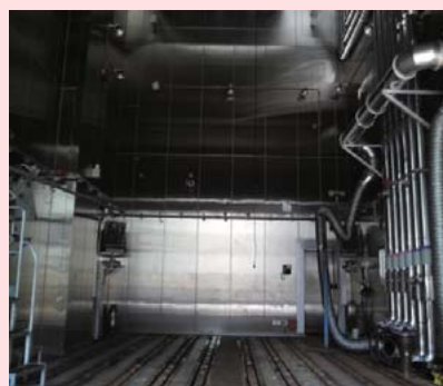
9 株式会社小松製作所建設機械用低温試験室冷凍設備の主な仕様(上)、低温試験室(左下)と冷凍機機械室(右下)
