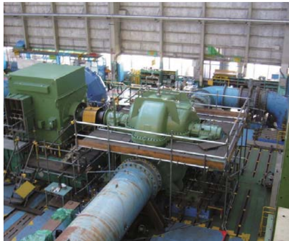
14 試験中の冷却水循環ポンプ(左)、組立完成後の海水取水ポンプ(右)
