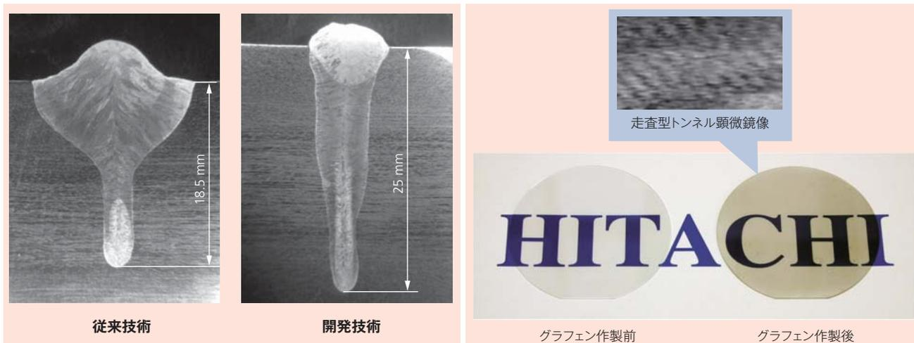
3 出力10 kWでステンレス (SUS316L) をレーザー溶接した場合の溶け込み形状 4 グラフェン作製前後のサファイア基板と作製したグラフェンの走査型トンネル顕微鏡像
