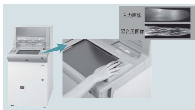
[3] 指静脈で本人確認を行う現金自動取引装置（左）と指静脈認証方式（右）
