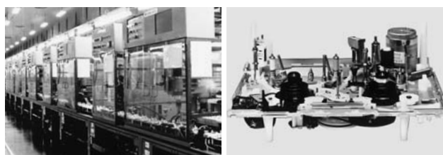
[5] VTRのFAライン（左）と組立てられた機構部（右）
