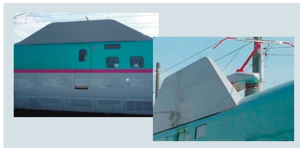
図3 E5系新幹線電車（量産先行車）のパンタグラフと遮音板 高速新幹線に搭載されているパンタグラフとその周囲を覆うパンタグラフ遮音板は風切り音の低騒音化を目標に開発した。
