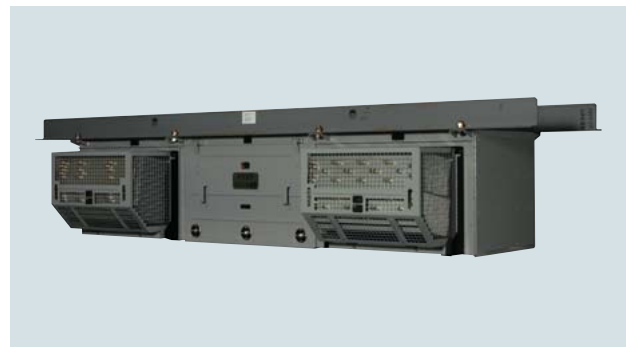
図1 次世代小型高性能インバータ 新技術の採用により、小型・軽量を実現した鉄道用VVVF (Variable Voltage Variable Frequency) インバータを示す。
