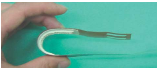
図7 | フレキシブル渦電流探傷センサー 曲面にも追従するフレキシブル渦電流探傷センサーを曲げた状態を示す。
