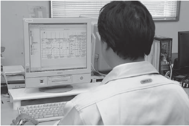
図4 | 株式会社キョクレイ大黒物流センターでのAirSense活用シーン 統合管理ソフトウェア「AirSenseWare」により、オフィス内のPCから倉庫内のすべての温度・湿度データを見渡すことが可能となった。
